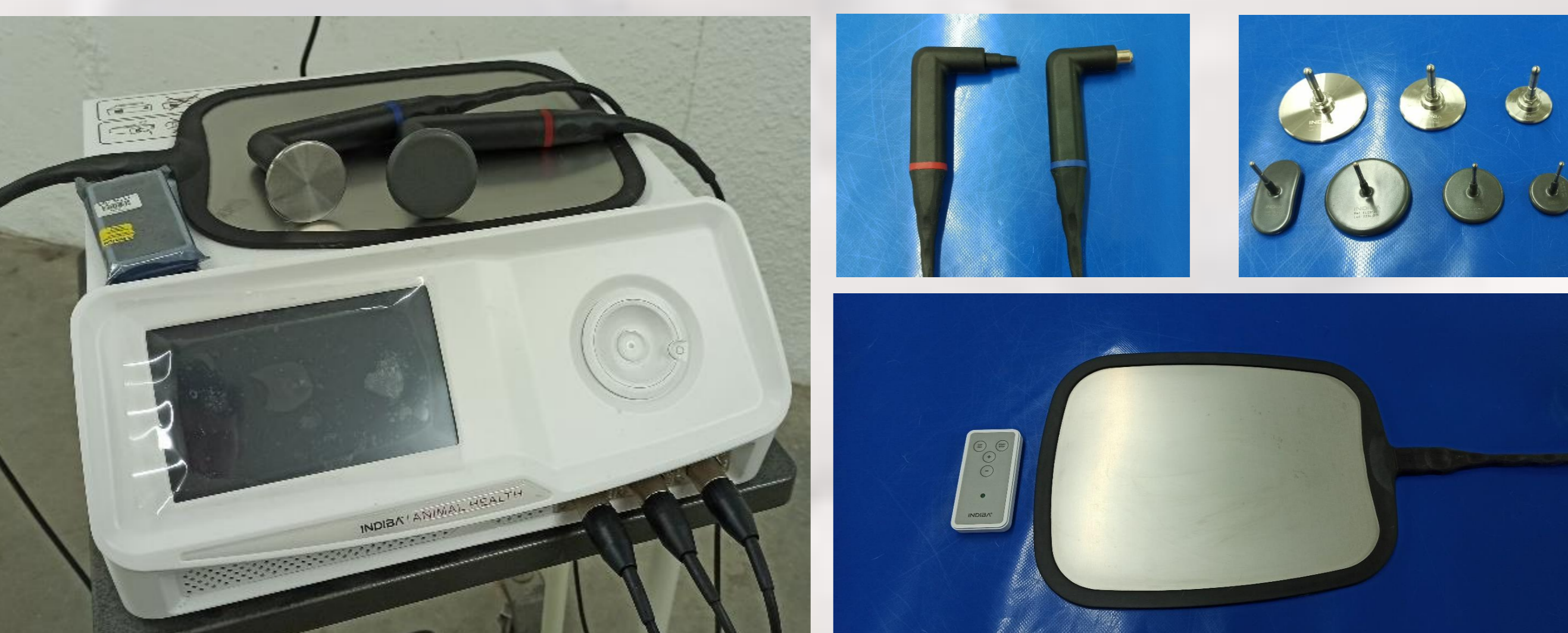
Figura 1. A, Uno de los equipos de terapia con radiofrecuencia monopolar capacitiva/resistiva a 448kHz (Indiba® Animal Health). B, Electrodos activos (franja roja, capacitivo; franja azul, resistivo) sin cabezales. C, Cabezales de los electrodos activos. En fila inferior cabezales recubiertos de poliamida utilizados en el modo capacitivo. D, Electrodo de retorno ("placa")B, imagen de una en la sesión de tratamiento.
